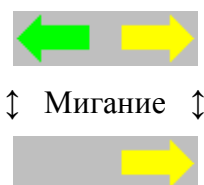
Рисунок 12.10 – Индикация «привязки» станции на отправление
