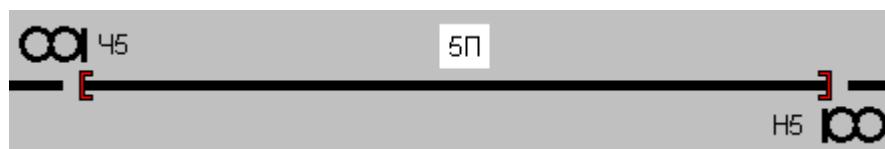
Рисунок 14.4 – Индикация огражденного пути
