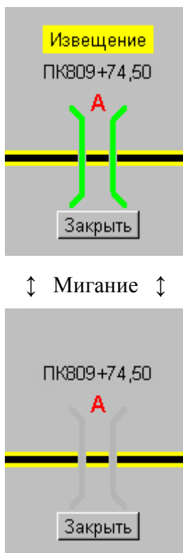
Рисунок 17.5 – Индикация автоматической подачи извещения на закрытие переезда при несрабатывании переездной автоматики (вариант 2)
