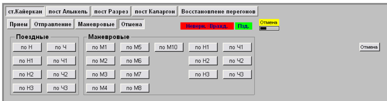
Рисунок 27.4 – Панель управления. Подвкладки станций круга удаленного управления
