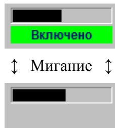
Рисунок 18.2 – Индикация выключения системы оповещения монтеров пути
