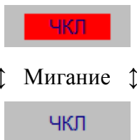
Рисунок 9.17 – Индикация неисправности жил кабеля
