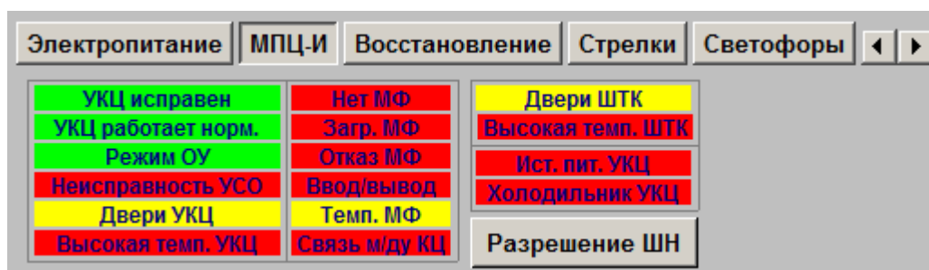
Рисунок 26.1 – Элементы контроля устройств УКЦ и ШТК
