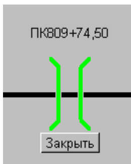
Рисунок 17.2 – Индикация переезда в открытом и исправном состоянии
