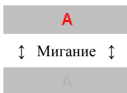
Рисунок 17.6 – Индикация аварии в релейном шкафу переезда
