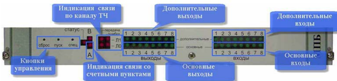
Рисунок 1.7 – Лицевая панель модуля контроллеров МПБ
