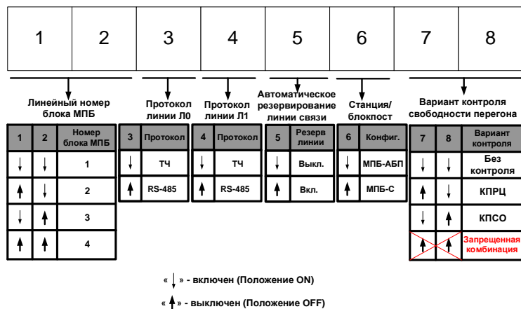
Рисунок 1.3 – Значения разрядов конфигурационного переключателя S4
