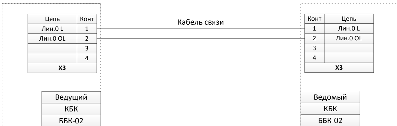
а) Схема организации связи по физической линии
