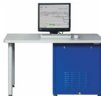
Автоматизированное рабочее место электромеханика АРМ ШН
