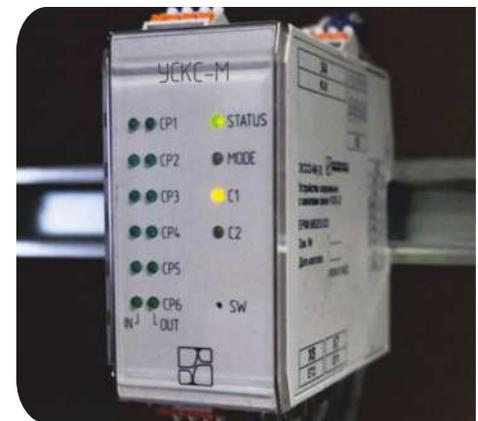
Устройство сопряжения с каналами связи УСКС-М
