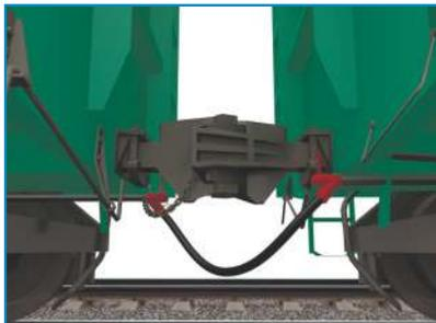
Системы автоматического контроля механизма автосцепки
