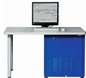
Автоматизированное рабочее место электромеханика АРМ ШН
