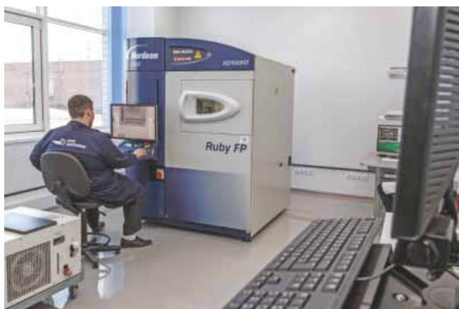
Контроль монтажа платы на рентген-установке DAGE
