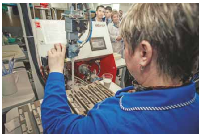
Процесс заливки компаундом на автоматической системе двухкомпонентной заливки DOPAG ELDOMIX
