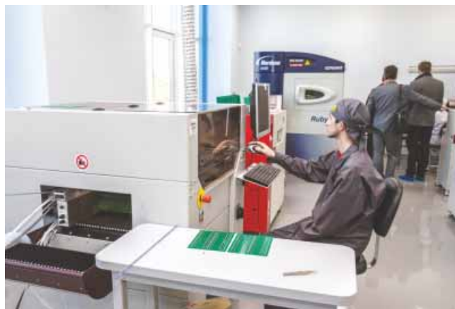
Оператор поверхностного монтажа за работой на автомате по установке радиоэлектронных компонентов
