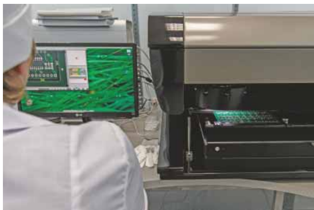
Процесс контроля пайки радиоэлементов через оптическую инспекцию
