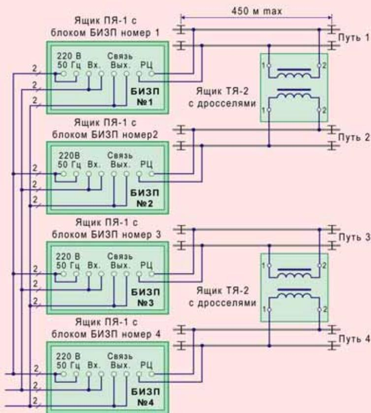
тков подключаются дроссели, контролирующие рельсовую цепь при свободном пути (рис. 3). Для устойчивой работы напольной аппаратуры КЗП ИЗ на всех стыковых соединениях устанавливаются перемычки.
