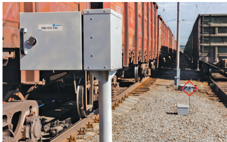
Пульт местного управления устанавливается в междупутье в непосредственной близости от тормозного упора
