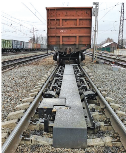
Внешний вид тормозного упора КТС АЗС
