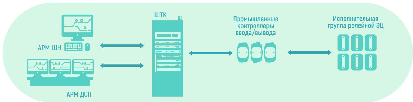
МПЦ-И с релейно-контактным интерфейсом
