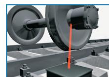
Позиционирование в системах контроля нагрева букс
