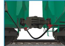
Системы автоматического контроля механизма автосцепки
